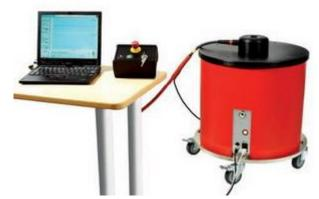
непосредственно на месте проведения измерений или позже в офисе. Локализация мест повреждений ЧР производится методом рефлектометрии.
